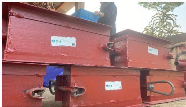
*Gambar 6. Alat cetak paving batako manual*
