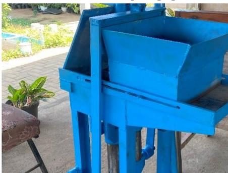
*Gambar 3. Alat cetak paving semi-hidrolis*
