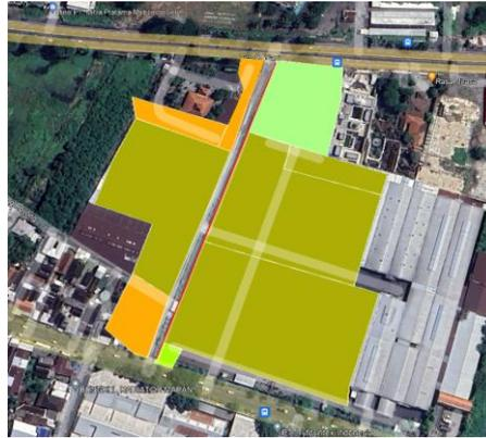
**Gambar 2.** Luas Daerah Tangkapan Air Saluran Drainase di Jalan Jembangan
