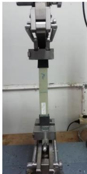
Gambar 3. Pengujian Tarik Komposit GFRP Hand Lay-up
