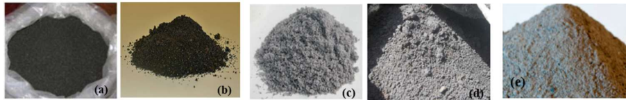
Gambar 3. Jenis terak non-besi: (a) tembaga, (b) nikel, (c) fosfor, (d) timbal dan (e) seng [15]
