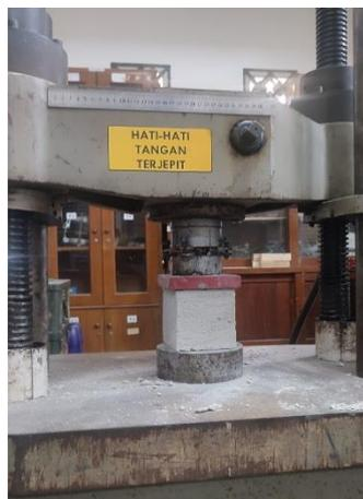
**Gambar 3** Pengujian Kuat Tekan Bata Ringan
