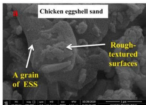
Gambar 1. Foto SEM beton dengan serbuk cangkang telur
