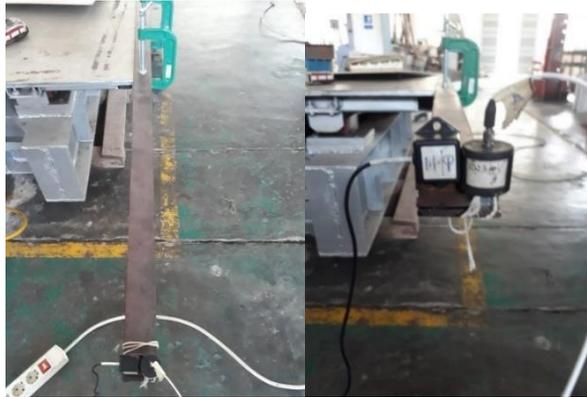
Gambar 3. Setting pengujian kalibrasi *accelerometer*
