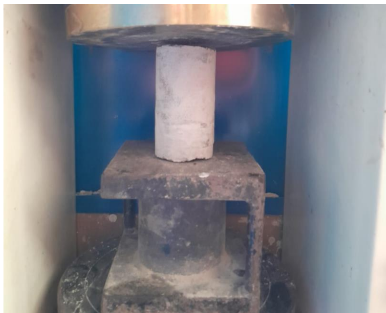
Gambar 4. Pengujian kuat tekan beton core drill
