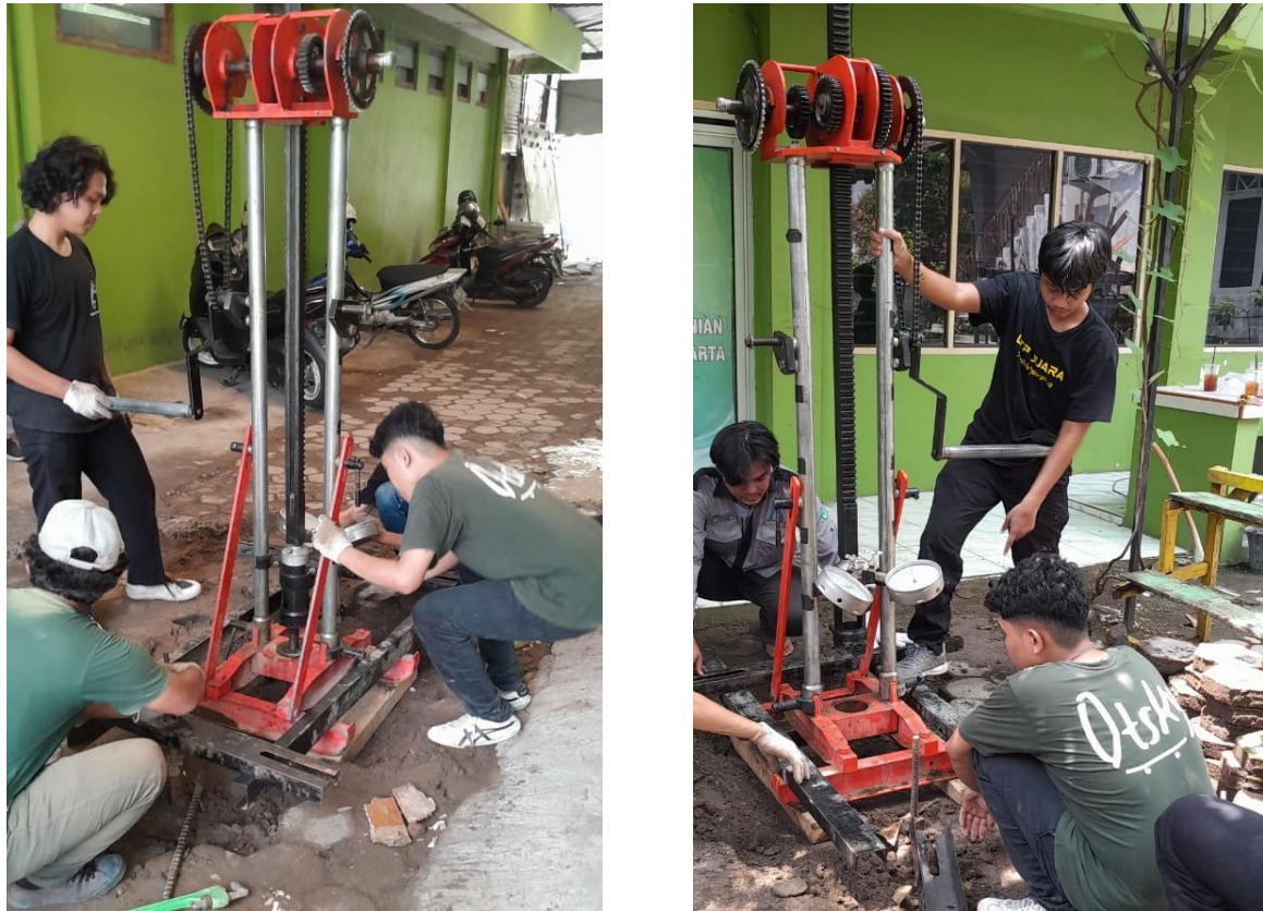
(a) (b) Gambar 3. Pengujian lapangan CPT (a) sisi barat (b) sisi timur
