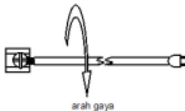
Gambar 4 Arah uji torsi
