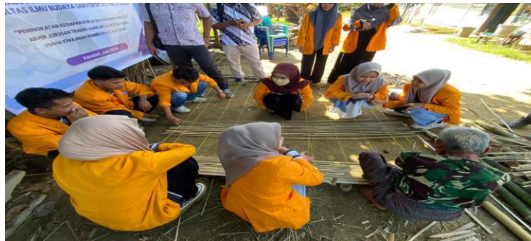
Gambar 5: Mahasiswa Merapikan Belahan Bambu yang Telah Disisipkan Pada Tali
