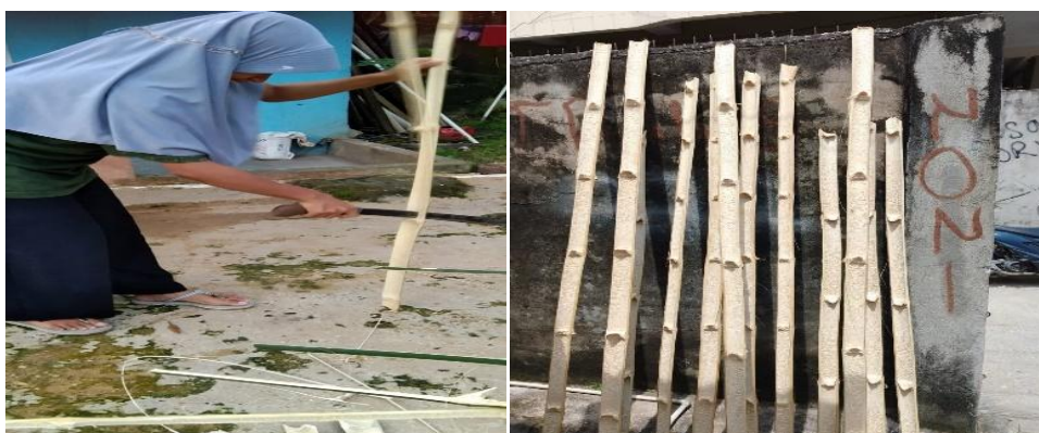
Gambar 3. Proses Pembelahan Bambu
