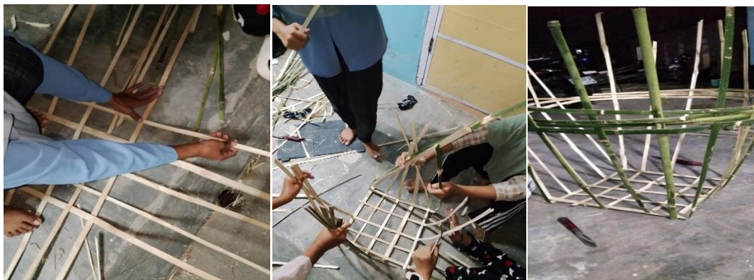
Gambar 5. Proses Menganyam dan Membuat Pola Dasar bawah dan Lingkaran
