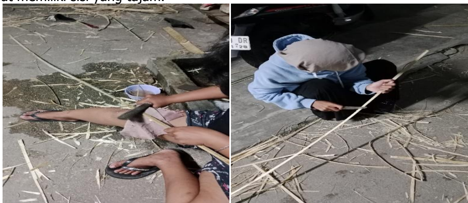
Gambar 4. Proses Pembersihan Ruas dan Pengirisan
