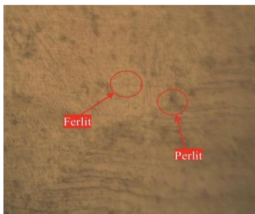
Gambar 10. pengelasan 100 A daerah Haz
