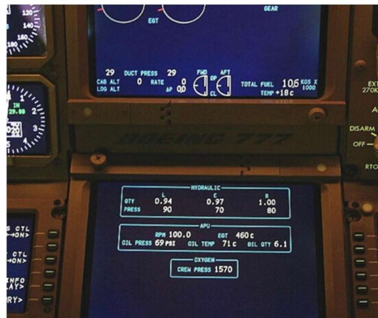
Gambar 4. Tampilan EICAS setelah APU Functional Test
