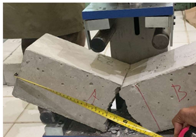
Gambar 2. Pengujian Kuat Lentur
