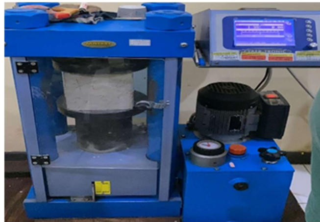
Gambar 1. Pengujian Kuat Tekan Beton
