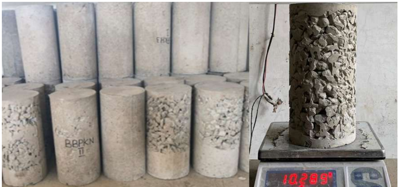
Gambar 5. Benda uji beton berpori bentuk silinder dan benda uji setelah berumur 28 hari
