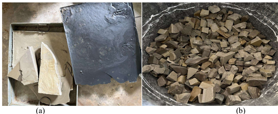
Gambar 3. Hasil pencetakan dan pemotongan HDPE yang telah mengalami proses peleburan (a), serta pecahan agregat HDPE yang digunakan sebagai substitusi agregat kasar pada campuran beton berpori (b).
