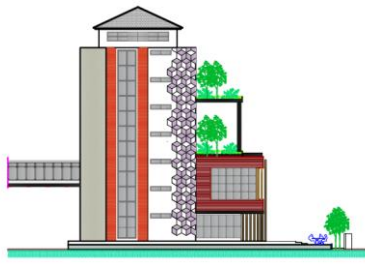
Gambar 6. Gambar Tampak Samping Bangunan Tampilan Perpustakaan Universitas Tunas Pembangunan mengadaptasi tampilan bangunan yang modern dengan penggunaan material kaca, tampilan bangunan tropis dengan adanya taman pada roof garden , dan penggunaan atap limasan sebagai cerminan bangunan yang masih satu komplek dengan bangunan utama kampus.
