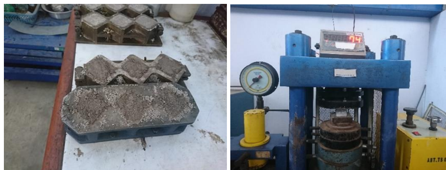
Gambar 3. a) Cetakan mortar logam, b) Pengujian kuat tekan mortar dengan mesin UTM
