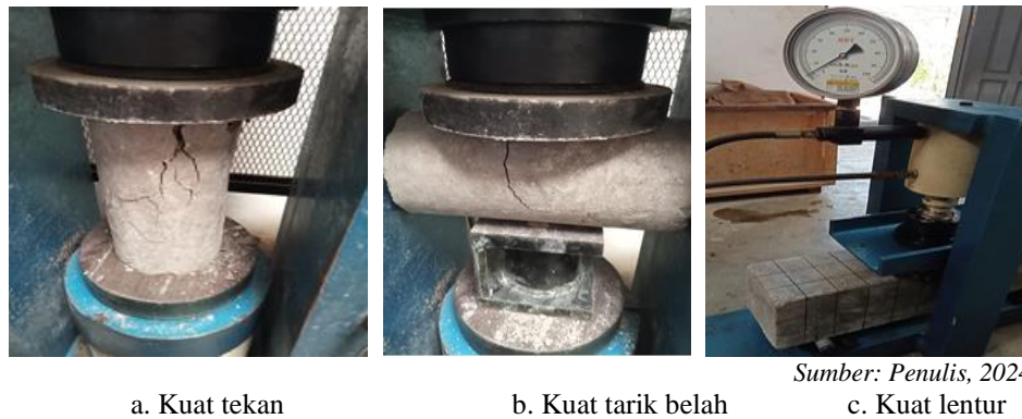
Gambar 1. Pengujian kuat tekan, kuat tarik belah dan lentur
