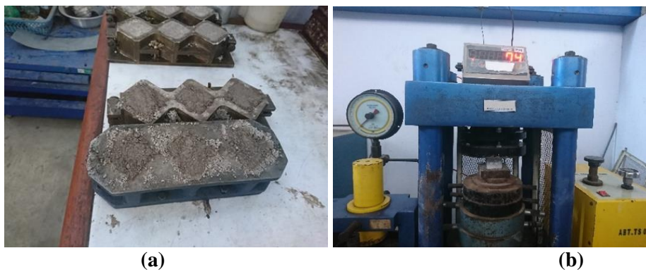
Gambar 3. a) Cetakan mortar logam, b) Pengujian kuat tekan mortar dengan mesin UTM
