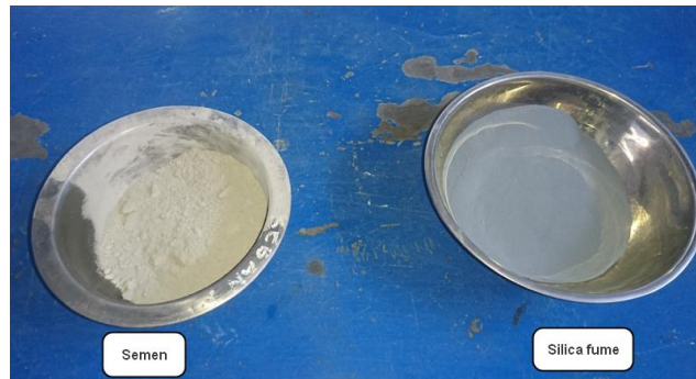
Gambar 4. Perbandingan kondisi fisik semen Portland (kiri) dan silica fume (kanan)
