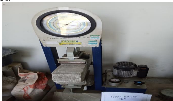
Gambar 9. Pengujian kuat lentur.
