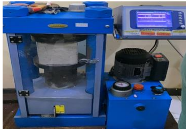
Gambar 1. Pengujian Kuat Tekan Beton
