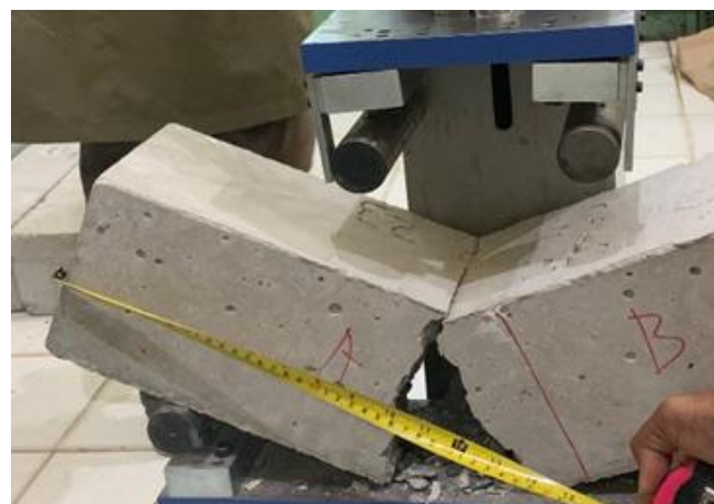
Gambar 2. Pengujian Kuat Lentur
