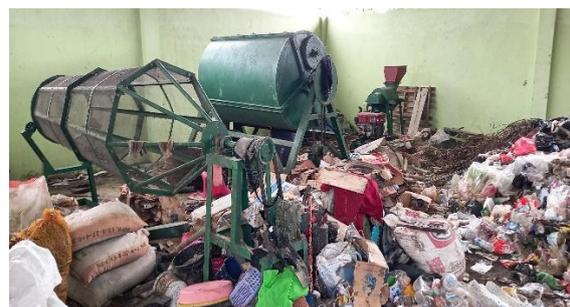
**Gambar 3.** Mesin pencacah bahan organik, penyaring dan pembuatan kompos
