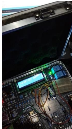
Gambar 4. Praktek dan Simulasi antarmuka dengan LCD 16x2 I2C
