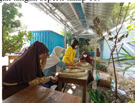
Gambar 9: Tahap Filler menutup Pori-pori Komponen
