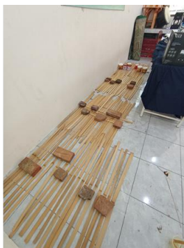
Gambar 1 dan 2: Tahap Menyambung Irat Bambu
