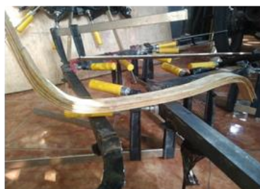
Gambar 4, 4a dan 5: Proses Bending setelah Laminasi dan Hasil Bending
