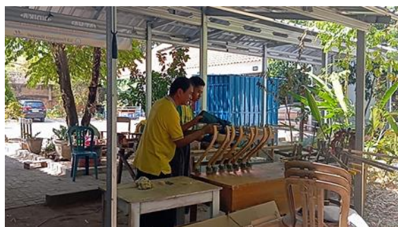
Gambar 10: Mewarnai Komponen yang sudah di filler dan dihaluskan
