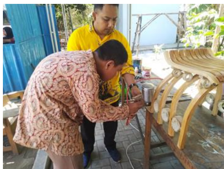
Gambar 13: Finishing dengan Cat Melamin Semprot
