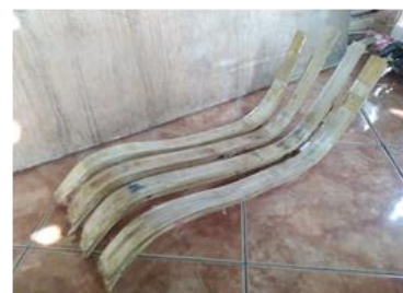
Gambar 4, 4a dan 5: Proses Bending setelah Laminasi dan Hasil Bending
