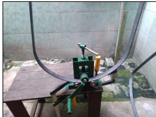
Gambar 3: Proses Mem-bending besi
