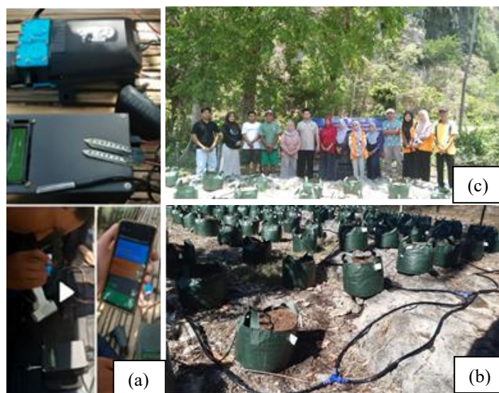
Gambar 2. (a) Perakitan alat sensor Auto drip irrigation (ADI) dengan aplikasi Blynk (b) Pemasangan instalasi pada planterbag , (c) Foto Bersama peserta pelatihan
