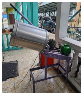
Gambar 3. Mesin Pengaduk Olahan Ubi menggunakan Solar Cell secara Otomatis
