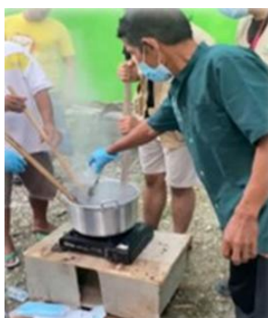
Gambar 5. Mencampurkan bahan pasir kedalam olahan eco paving block
