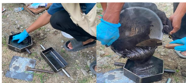
Gambar 6. Proses memasukkan adonan Eco Paving Block kedalam cetakan
